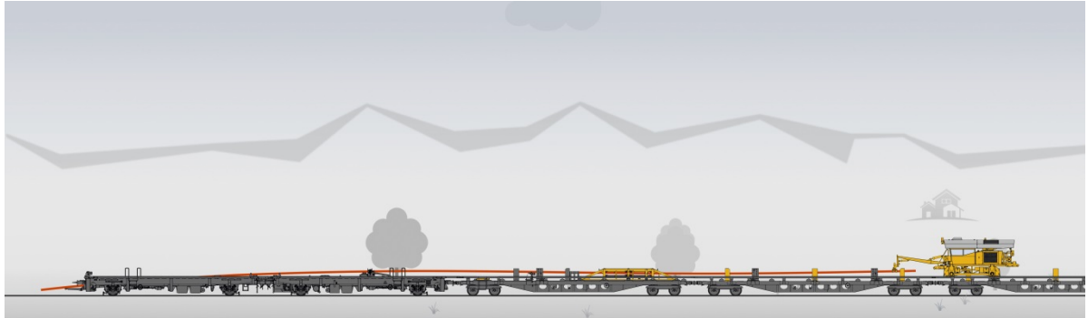
III. 8: REX-S, se composant d'un chariot coulissant, d'une unité de transport et d'un manipulateur de rails, décharge une paire de rails de 180 m en deux minutes et les charge en quatre minutes.
