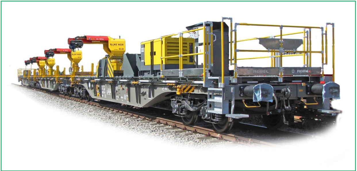
III. 2: La mise en place flexible des grues de chargement ainsi que les niveaux d'automatisation en option font du chargeur de rails 40.44 un véritable talent universel à facteur de sécurité élevé.
