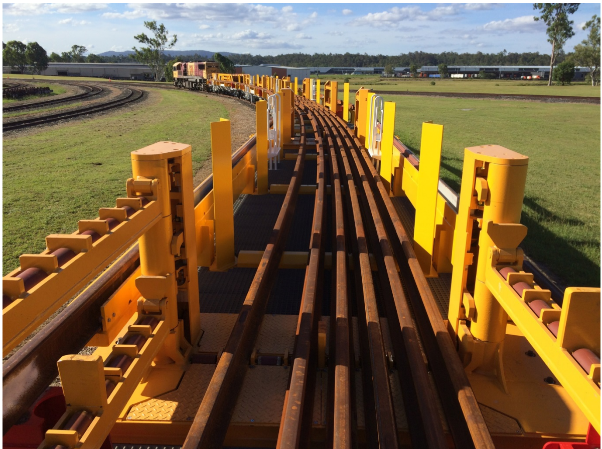
III. 9: Jusqu'à 50 rails d'une longueur maximale de 500 m sont transportés en toute sécurité à l'intérieur des limites de cintrage et d'étrépage
