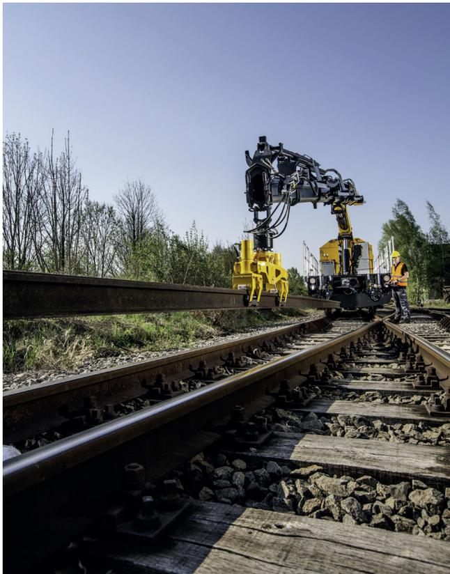
Bild 3. Ein am Gleiskraftwagen montierter Ladekran mit Schienenzange lädt die vom System transportierten Schienen ab.
