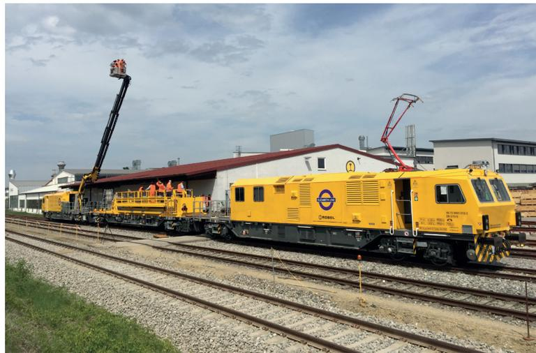
Bild 4. RORUNNER System modular ausgestattet mit Mannschaftsraum, Scherenhebebühne und Ladekran mit Arbeitskorb für die Instandhaltung von Oberleitungen (Bilder: ROBEL Bahnbaumaschinen GmbH).
