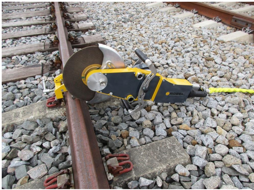
ill. 2 : Poids plume performant: La nouvelle tronçonneuse de rails ROCUT B effectue 50 coupes avec un accu.
