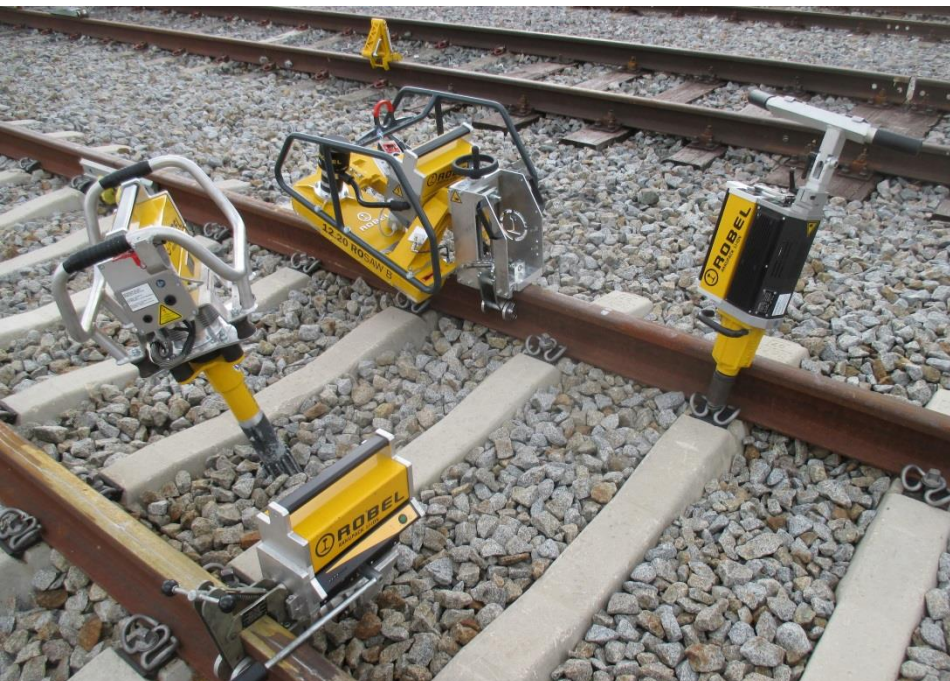
iii. 1 : Les quatre types de machines de la famille d'accu Robel fonctionnent avec le même accu ions-lithium.
