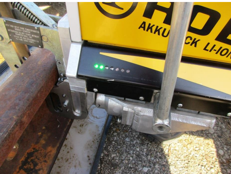
ill. 5 : Travail à assistance électronique : L'affichage à LED de la perceuse pour rails sur accu signale le niveau de la puissance délivrée lors de l'avance manuelle.
