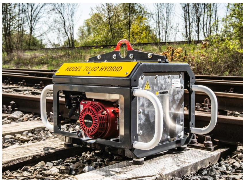
ill. 8: Chariot de transport avec fonction supplémentaire : L'accu haute performance est monté bien protégé à l'intérieur.
