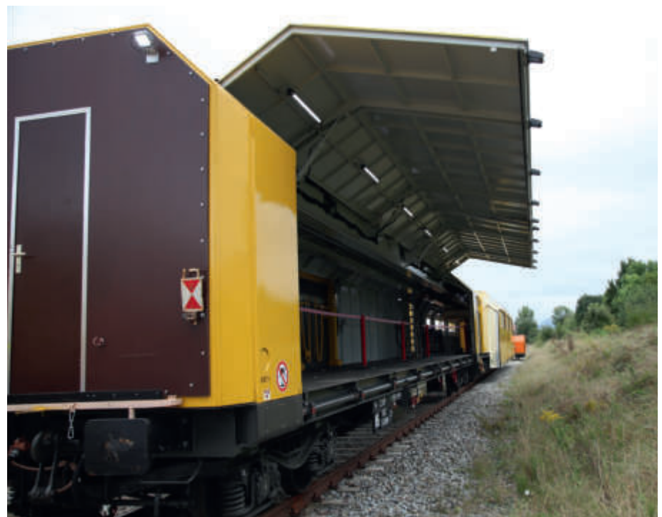
Abb. 3: Ganz oder teilweise hochklappbare Seitenwände für komfortables Be- und Entladen des Zwischenwagens.
