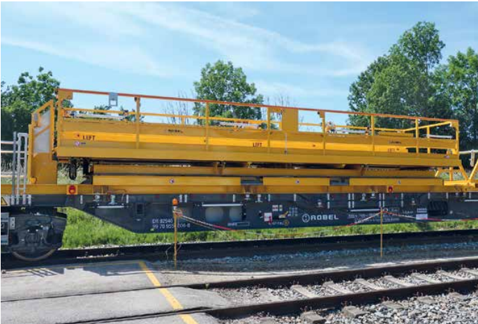
Oben links: Einer der RORUNNER-Gleiskraftwagen trägt einen Hydraulikkran. Oben rechts: Am 6. September 2018 wurden die RORUNNER Systeme an Transport for London (TfL) übergeben. Unten links: Eine verstellbare Arbeitsplattform bietet die auf einen Transportwagen aufsetzbare Scherenhebebühne ROHOIST. Unten rechts: Auf der Elizabeth Line kommen 70 neue Elektrotriebzüge der Class 345 zum Einsatz.
