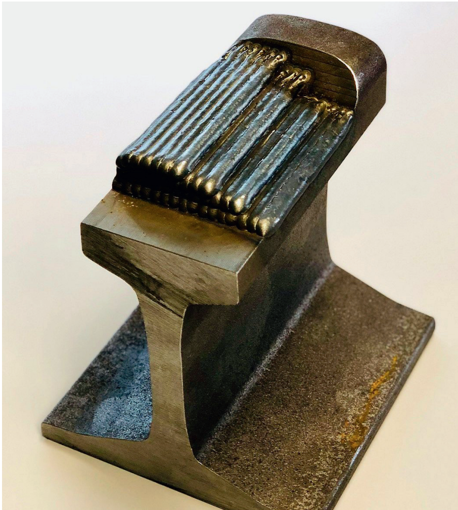
Abb. 6: Statt Bauteile auszutauschen, wird die ursprüngliche Geometrie in kurzer Zeit schichtweise rekonstruiert und somit vollständig wiederhergestellt.
