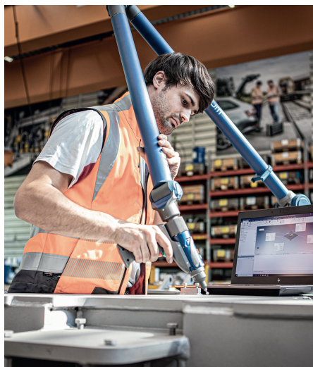
Abb. 3: Die digitalisierte Rahmenvermessung liefert reproduzierbare Ist- und Sollwerten im Verhältnis zu den Normtoleranzen in der halben Zeit einer manuellen Vermessung.
