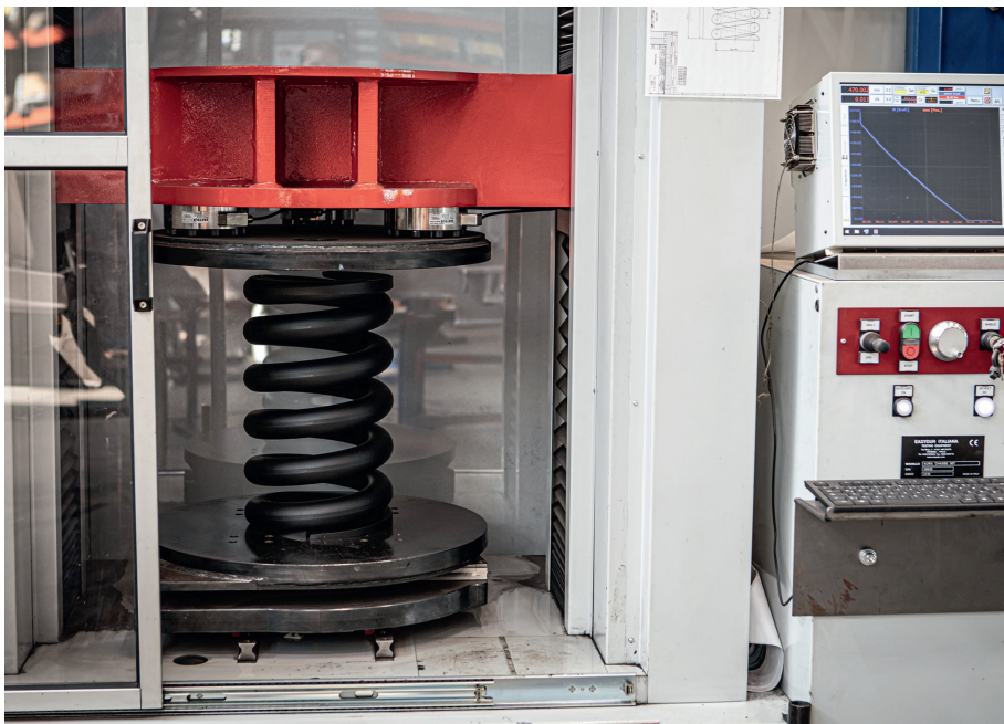
Abb. 4: Ein kalibrierter Messstand prüft die Primär- und Sekundärfederung der Drehgestelle.
