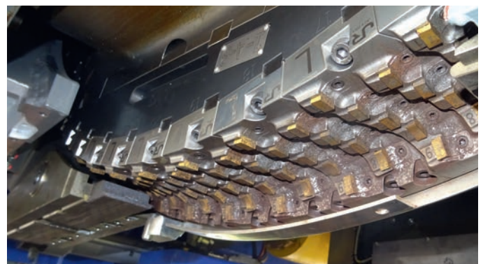
Abb. 2: Die stehend auf dem Fräsrad platzierten Schneideplatten ermöglichen eine erhöhte Anzahl an Schneiden für noch effektiveres Fräsen.
