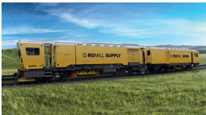
Abb. 1: Das zweiteilige Schienenfrässystem Romill ist das erste Produkt von Robel im Bereich der Schienenbearbeitung. Quelle aller Abb.: Robel
