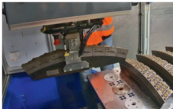
Abb. 4: Halbautomatischer Segmentwechsel innerhalb des Wartungsraumes
