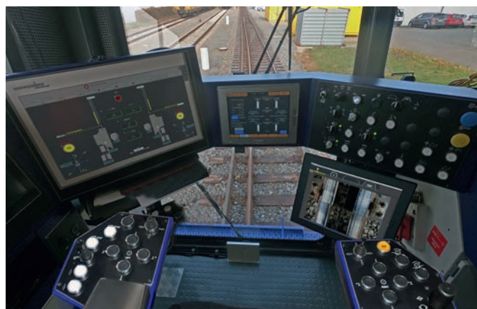
Abb. 6: Gleis und Maschine im Blick: Innerhalb der Kabine befinden sich die Anzeigen (von links nach rechts) für Messsystem, Fräs- und Schleifaggregat und Außenkamera sowie die Bedienelemente für Schleifaggregat, Absaugung und Messung.
