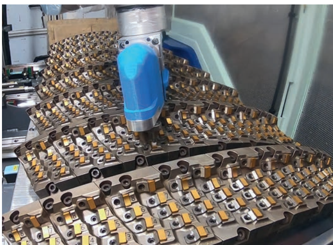
Abb. 5: Ein kollaborierender Roboter verschraubt und löst die Wendeschneideplatten.
