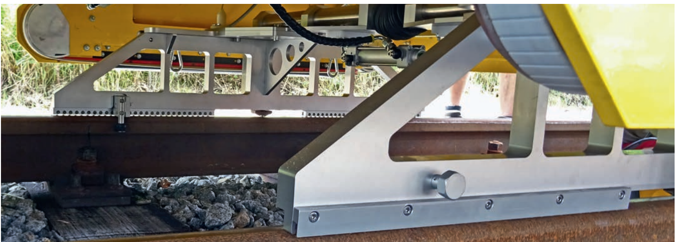
Abb. 9: Der Sensorkopf des RMF 1100 Messsystems erfasst die Längswelligigkeit der Schiene nach dem Schleifvorgang.
