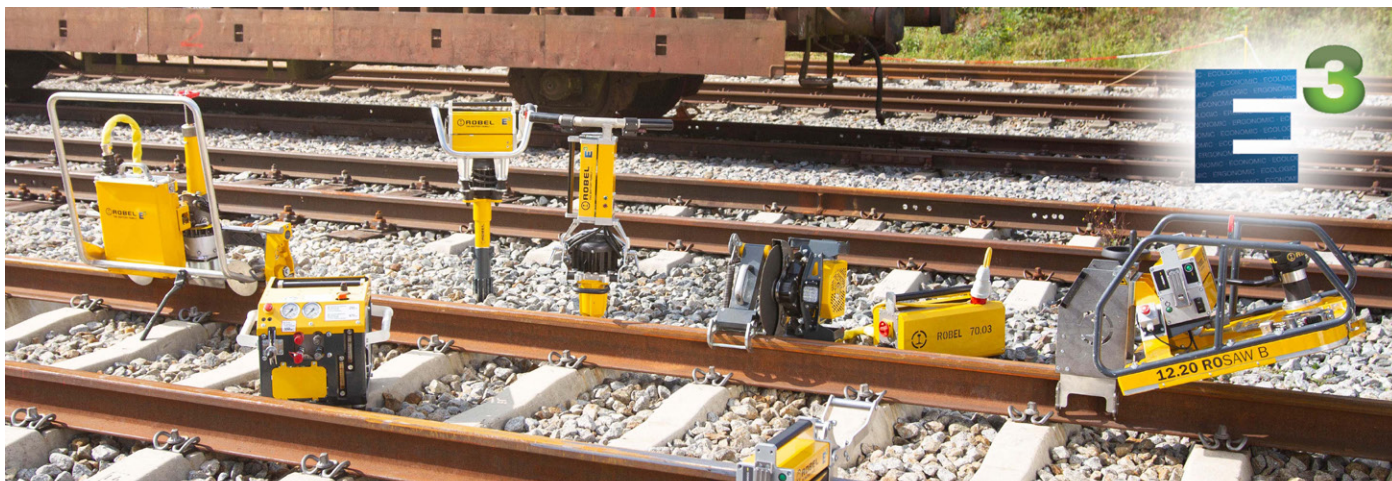
Abbildung 1: Die E 3 -Maschinen von ROBEL: Schleifmaschine 13.45 MD, Hochdruck-Hydraulikaggregat 76.20, Vertikal-Schwingstopfer 62.20L, Schlagschraubmaschine 30.20, Schienen-Trennschleifgerät 13.90, Schienenbohrmaschine 10.20, Netzteil 70.03, Schienenbandsäge 12.20. Alle werden durch auswechselbare Hochleistungsakkus angetrieben. © Robel
