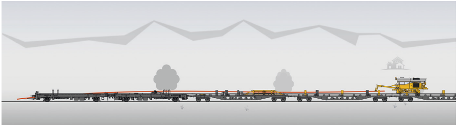
Abb. 8: REX-S, bestehend aus Rutschenwagen, Transporteinheit und Schienenmanipulator, lädt ein Paar 180-m-Schienen in zwei Minuten ab und in vier Minuten auf.
