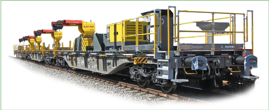
Abb. 2: Die flexible Anbringung der Ladekräne sowie optionale Automatisierungsstufen machen den Schienenlader 40.44 zu einem echten Allrounder mit hohem Sicherheitsfaktor.
