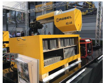
Abb. 4: Das Hybrid Power Pack optimiert die Generatoren-Leistung und senkt so Kraftstoffverbrauch und Emissionen.
