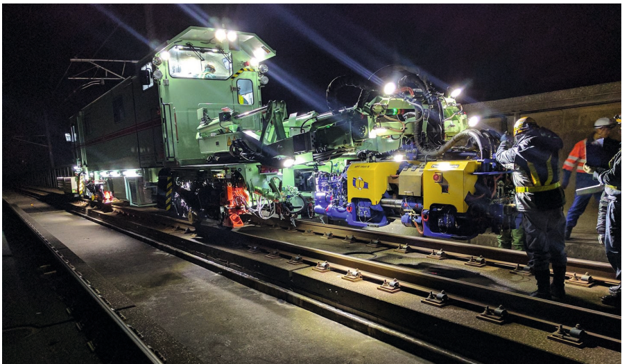
Abb. 11: Der mobile APT Schweißroboter von Plasser & Theurer ist Teil des am Shinkansen eingesetzten Schienenwechsel-Systems REX-S 1200.
