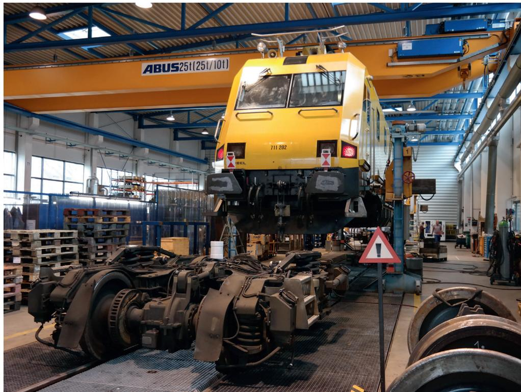
Abb. 6: Ausbau des alten Drehgestells im Rahmen einer Revision
