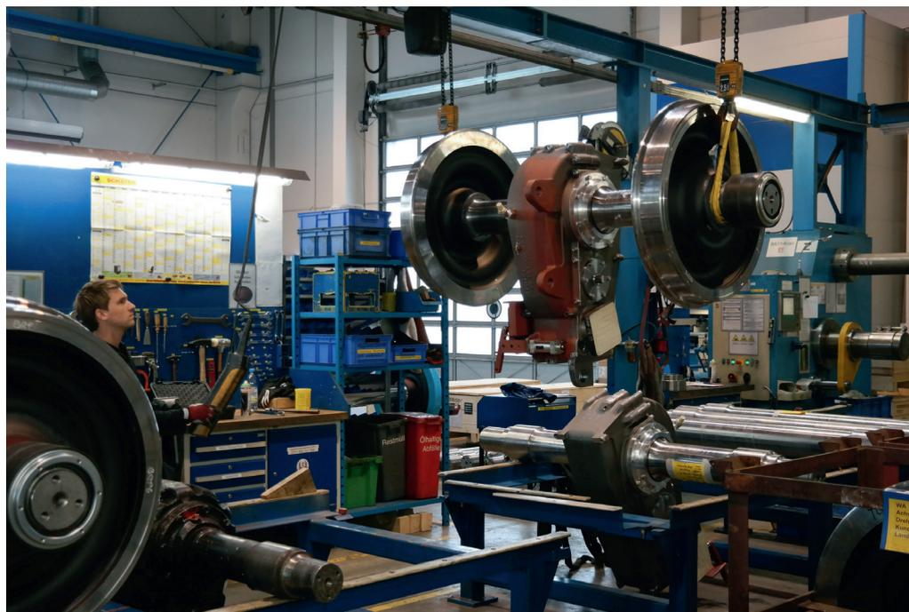
**Abb. 3:** Überarbeitung eines Radsatzes mit Achsgetriebe
