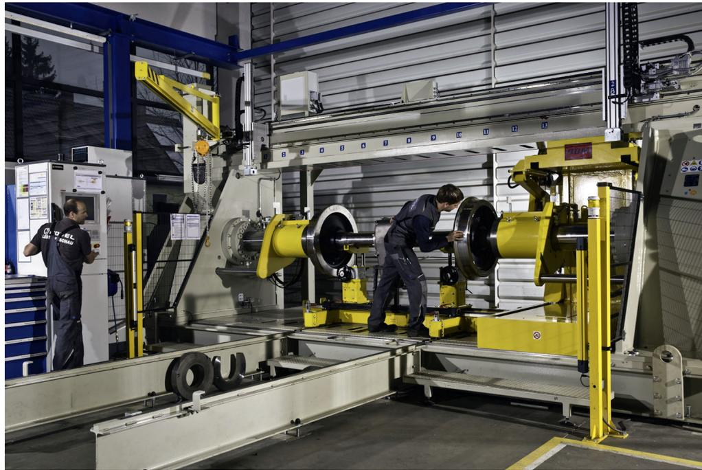
**Abb. 2:** Achspresse für automatisches Auf- und Abziehen von Rädern mit digitaler Überwachung und Protokollierung
