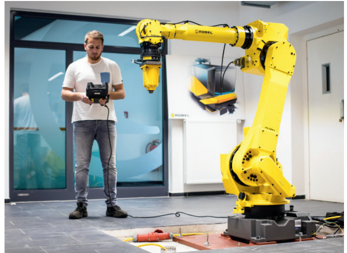
2: Erste Einsätze eines Gleisbau-Roboters unter Labor-Bedingungen im neu errichteten ROBEL Technikum in Freilassing.
