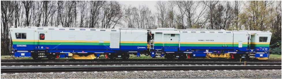
Abb. 8: ROBEL Schienenfräszug für Japan mit Fräs-, Polier- und Messaggregaten
