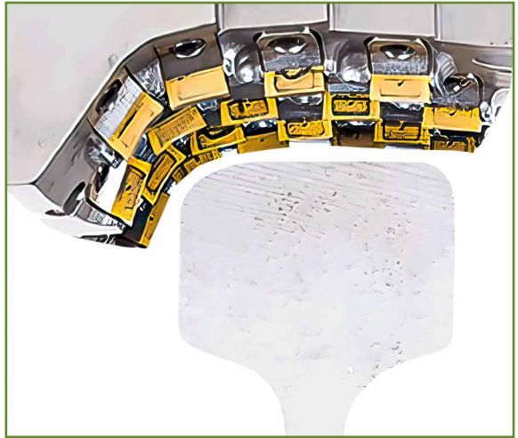
Abb. 7: Schienenfrästechnologie: Präzise Reprofilierung der Schiene über die Form des Messerkopfes
