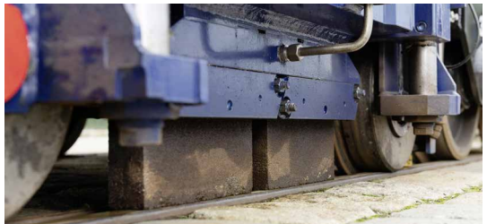
Abb. 6: Rutscherstein-Technologie zur Erzeugung einer lärmoptimierten Schienenoberfläche
