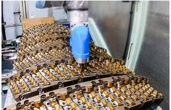
Abb. 9: Roboter-Unterstützung beim Tausch der Wendeschneidplatten auf der Schienenfräse des Types Romill.
