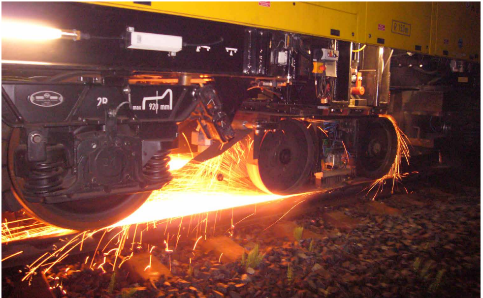
Abb. 5: Bandschleifer zur Nachbearbeitung nach dem Schienenfräsen
