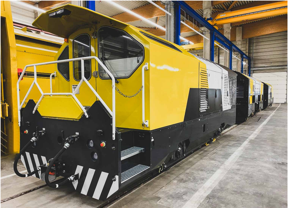
Abb. 11: Schienenfräszug Romill CMS3 mit Hybridantrieb bei der Fertigung
