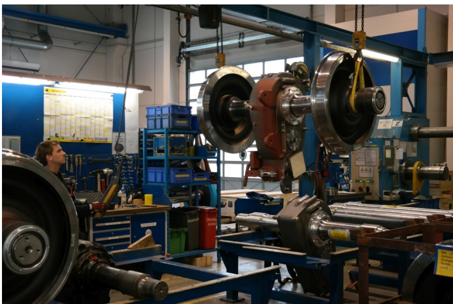
Ill. 3 : Révision d'un train de roues avec transmission sur essieux
