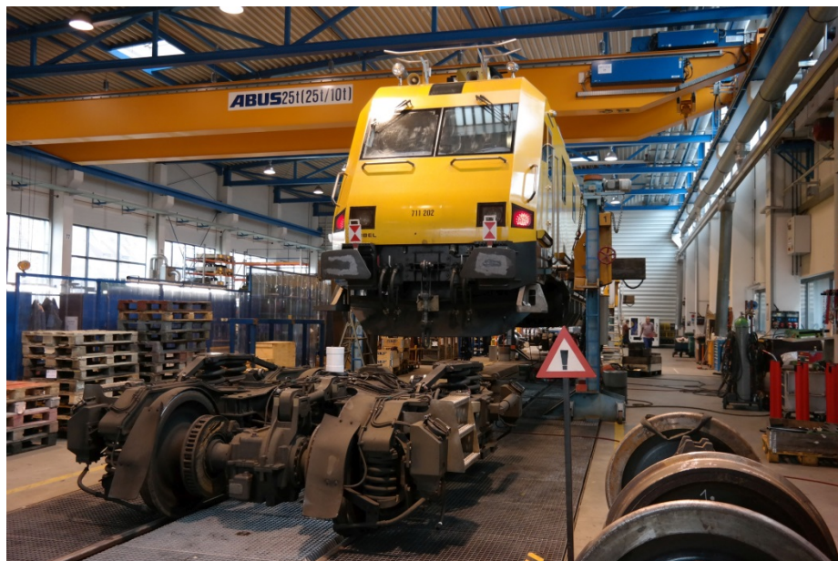
III. 6 : Démontage de l'ancien bogie dans le cadre d'une révision
