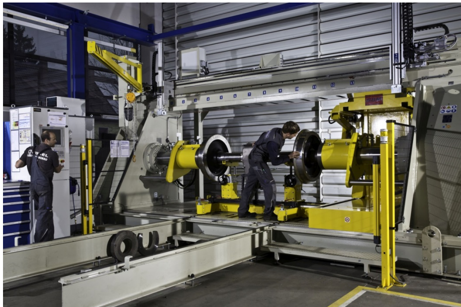
Ill. 2 : Presse à essieux pour la pose et la dépose de roues avec contrôle numérique et protocollage
